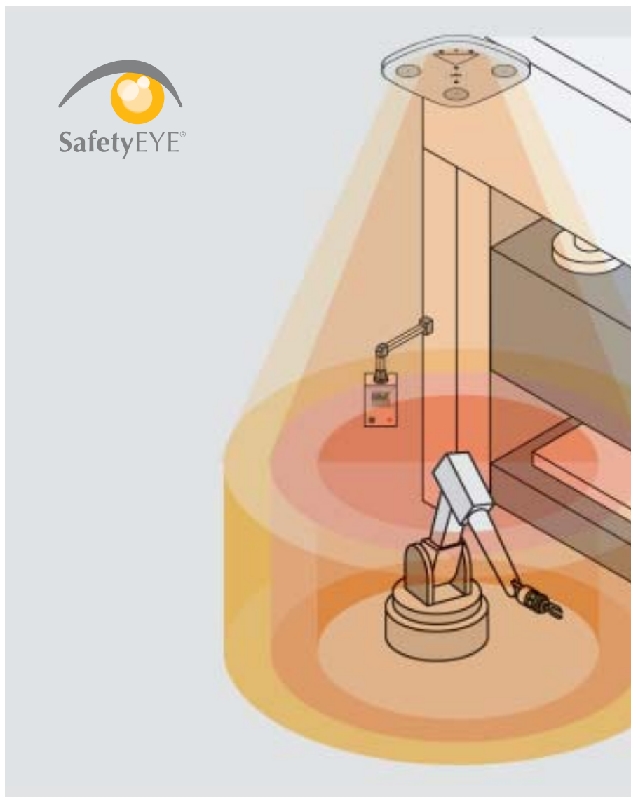
Interacción optimizada entre personas y máquinas: supervisión tridimensional de espacios con el sistema de cámaras seguro SafetyEYE.
